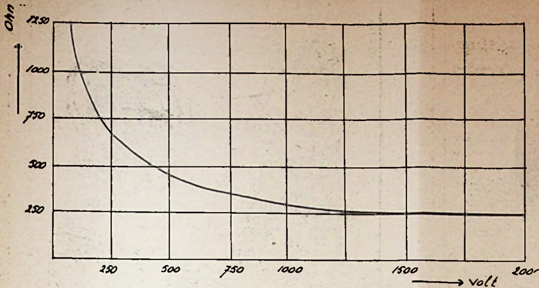
fig. 2: afhankelijkheid lichaamsweerstand van de spanning (volgens Wolter)
